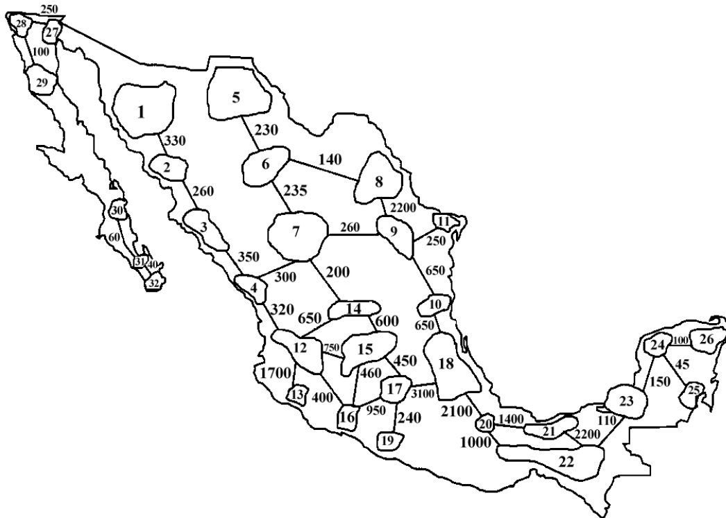
Figura 2.5. División del Sistema Eléctrico Mexicano en regiones mostrando la capacidad segura de transmisión en las interconexiones en 1998 (Adaptado de [Madrigal et al., 2004]).
